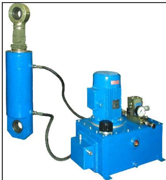
Aktuator je uređaj koji je osnovna namena ostvarenje velikih sila za kojene koje se najčešće uživaju za potrebe sidrenja kod velikih kranova. Pumpa pod pritiskom šalje ulje u komoru cilindra za uvlačenje i samim tim će se savladati sila opruge koja vrši sidrenje, kada je omogućeno kretanje krana. Sve vreme dok se kran kreće radi hidrauličnog agregata koji sada svaki kolnik ulja prete preko prelivnog ventila.
